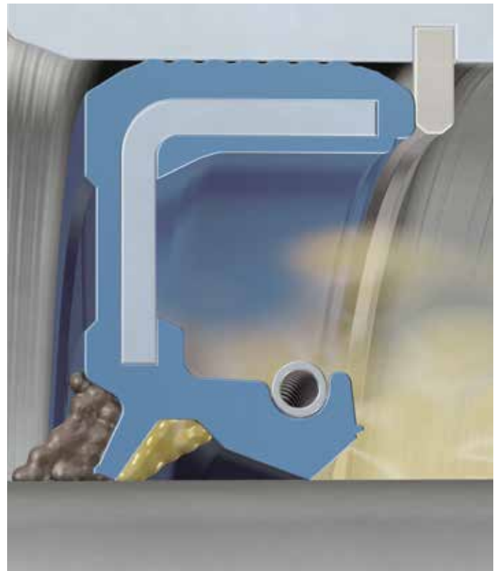
Ein eingespieltes Team: Dichtung und Schmierstoff verringern die Gefahr von Leckagen
